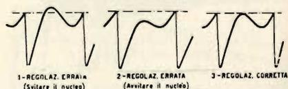
Fig. 9 - Oscillogrammi relativi ad un oscillatore bloccato orizzontale per TV.
