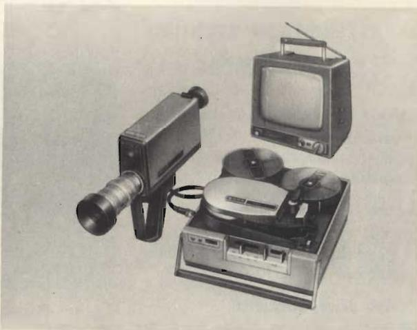
*Fig. 1 - Complesso registratore riproduttore video portatile AV-3400/AVC 3400 fotografato accanto ad un monitor Sony.*
